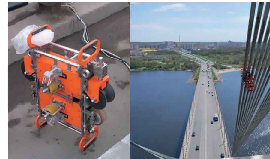
Фото 3. Плоская МГ для контроля близко расположенных канатов (Череповец)
